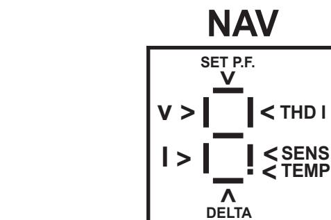
Il segmento del display NAV mostra il tipo di misura visualizzata. L'accensione del segmento indica quindi se il display a destra corrisponde o meno a quello di destra: Tensione, Corrente, Delta Power, Sensibilità, THD I%, Fattore di potenza impostato, Temperatura (il valore di temperatura viene visualizzato con il led DOT acceso).
